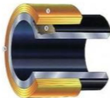
شکل ۴ - سطح مقطع لوله فولادی تعمیر شده با کامپوزیت
