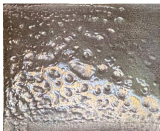
شکل ۳. تصویر پوشش نانو کامپوزیتی زمینه سیلیکونی حاوی ۲/۵٪ وزنی نانو ذرات اروزیل R972 اعمال شده بر روی کربن استیل.
