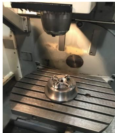
شکل ۱: فرزکاری جهت اندازه نهایی
