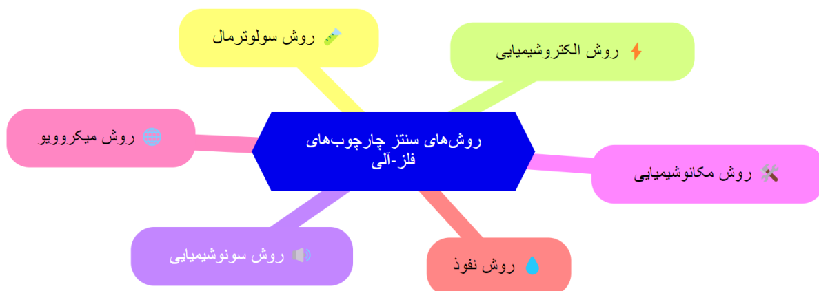
شکل ۲- روش های سنتز چارچوب های فلز-آلی
