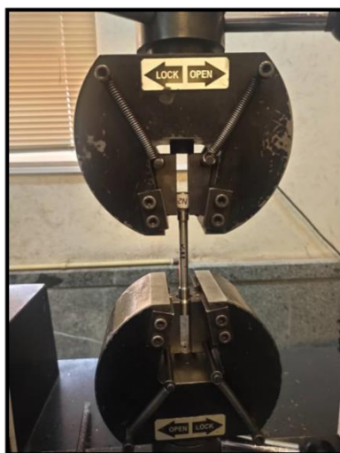
شکل ۳- دستگاه تست کشش و نمونه فولادی مورد آزمایش
