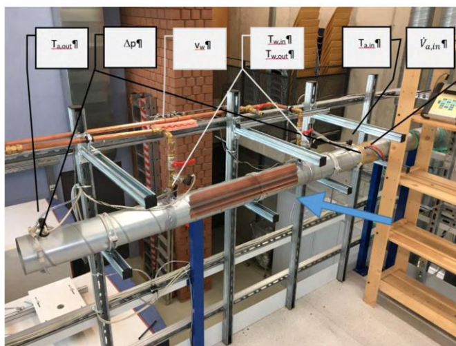
شکل ۱۲. قرار دادن سنسورهای اندازه گیری جدول ۲ در مجموعه آزمایشگاهی
